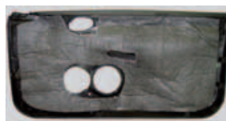
3. Türverkleidungs-Rückseite mit dem Dämmvlies bekleben.
